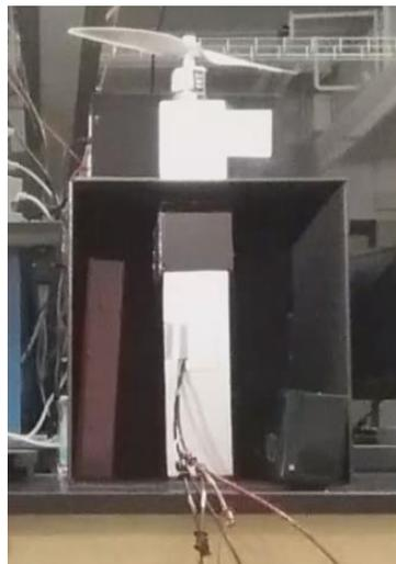
*Figure 5.5: Turnigy G60 motor testing apparatus*
